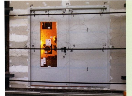
Tűzgátló ajtók és nyílászáró szerkezetek vizsgálata az MSZ EN 1634-1:2000 alapján
