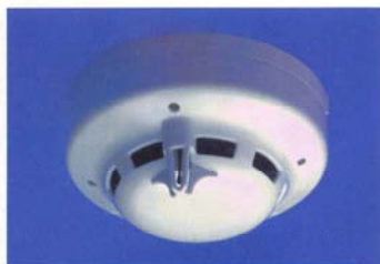
Érzékelő. A várható tűz típusa szabja meg, mely fajtákat érdemes használni
