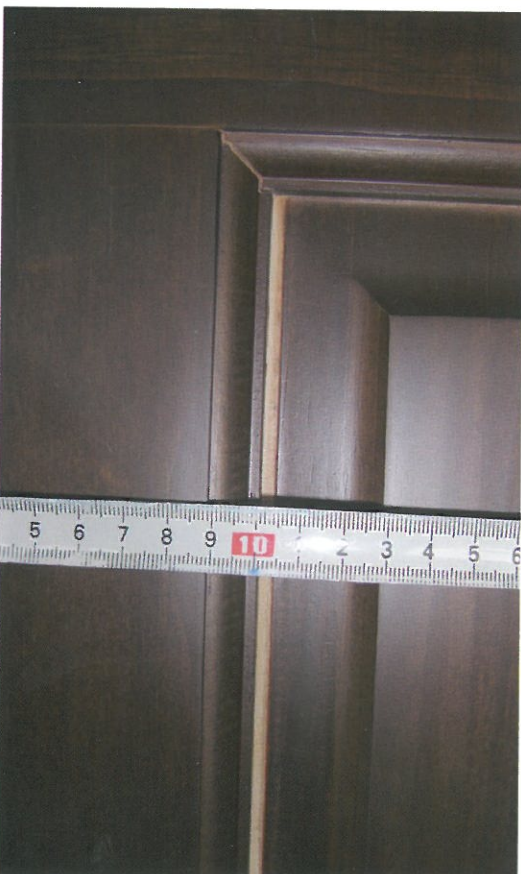
1. kép: Nedves alapanyagból gyártott belső téri ajtó betétjének méretváltozása a használatba étel után
